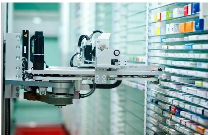
Сенсорная система содержит различные датчики, в первую очередь, датчики перемещения (угловые, линейные), обеспечивающие обратную связь в механизме перемещения. Показания датчиков отслеживаются системой управления.
