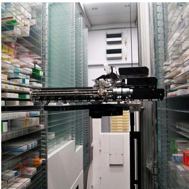
Механизм перемещения (манипулятор) включает каретку с закрепленным рабочим органом и привод.
