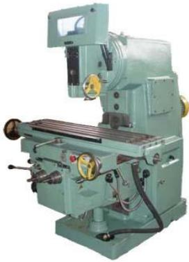
Фрезерный станок – это устройство, применяемое для обработки деталей из твердых типов материалов - металла, пластика, композитов или дерева с использованием фрезы, специального инструмента с вращающимися резцами.
