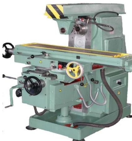
дополнительно оснащаются механизмом поворота шпинделя вокруг горизонтальной оси. Это позволяет изменять угол приложения фрезы, что существенно расширят возможности станка. Также шпиндель на некоторых станках имеет возможность перемещаться вдоль оси вращения, а также осуществлять движения в горизонтальной плоскости, что также увеличивает технологические возможности станка.
